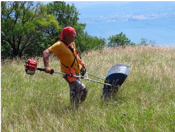
Figura 36: Macchine disponibili per la raccolta di fiorume, spazzolatrice a spalla (a sinistra), spazzolatrice trainata ad ampia regolazione dell'altezza di raccolta
