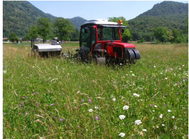
Figura 36: Macchine disponibili per la raccolta di fiorume, spazzolatrice a spalla (a sinistra), spazzolatrice trainata ad ampia regolazione dell'altezza di raccolta
